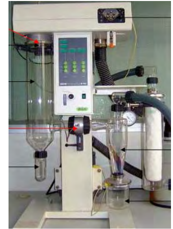
Spray-Dryer de laboratoire BUCHI (LAGEP)
